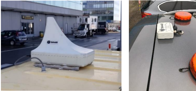
Figure 70 et 71. Transpondeur fixé sur le toit d'un véhicule
